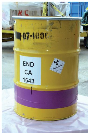
► Fût métallique de 200 L, utilisé entre autre, pour le conditionnement de déchets cimentés.
