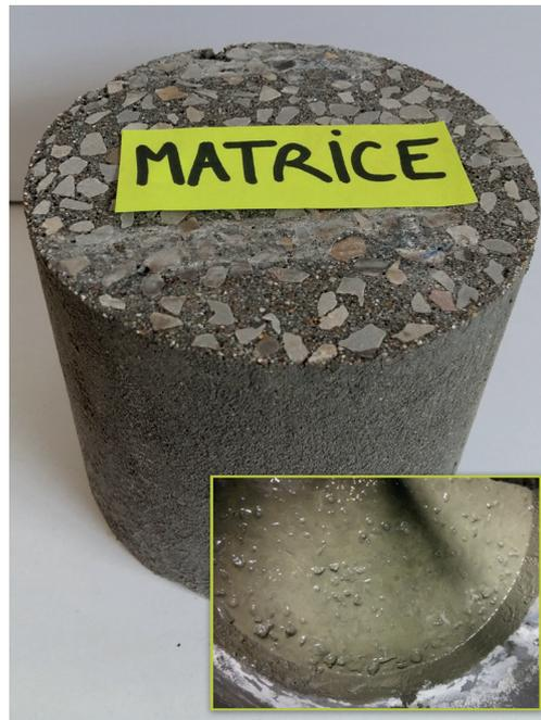
► Résultat du test du procédé de vibro-compaction.
